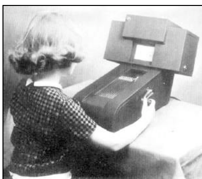
Figure 9.1. Machine pour l'enseignement de l'orthographe et de l'arithmétique, avec des glissières, des lettres et des chiffres pour la composition des réponses
